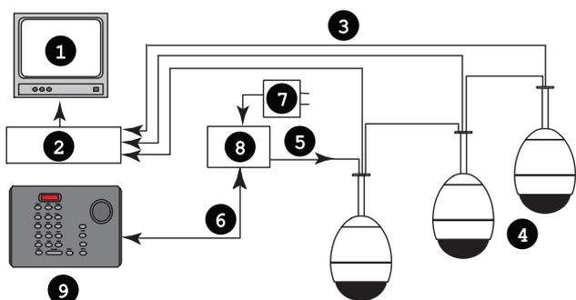
Размещение нескольких камер по схеме последовательного соединения контрольного кода Bi-Phase
